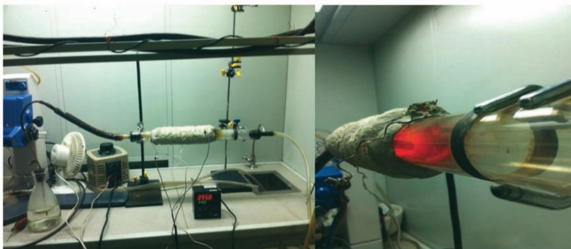
Рисунок 1 –Ректор для синтеза УНТ
