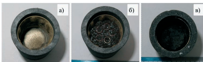
Рис. 2. Этапы изготовления слитка прототипного кориума а) тигель с TaC-вставкой; б) тигель со вставкой и шихтой; в) тигель со слитком кориума
