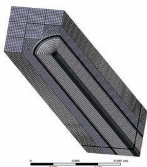
Рисунок 4 – Расчетная сетка тепло-гидравлической модели реактора ИГР.
