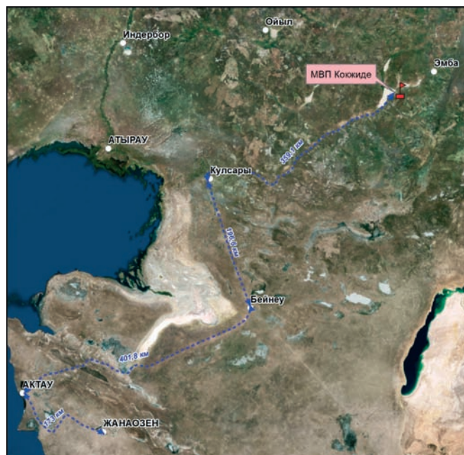
Рис. 2 - Проектная трасса водовода Месторождение Кокжиде - Кульсары-Бейнеу-Жанаозен-Актау
